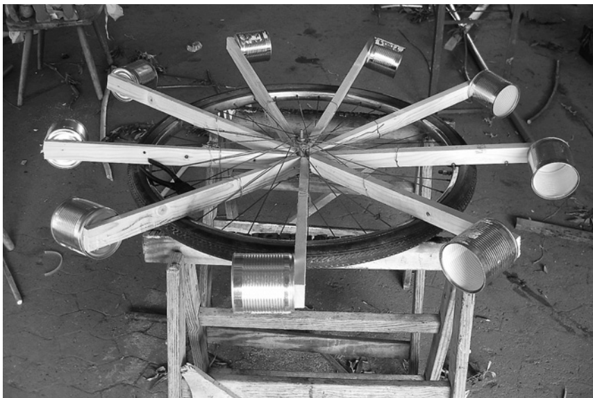
Wasserkraftwerk im Bau
